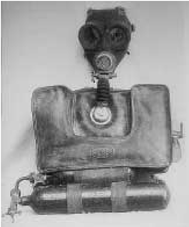
Fig. 8 – L'ARO "modello 49" della ditta I.A.C. una consociata della Pirelli, che nel 1935 si aggiudicò la prima fornitura di ARO alla Marina Militare Italiana per gli incursori piloti dei Siluri a Lenta Corsa (SLC) meglio conosciuti come "maiali" (da "I mezzi d'assalto" – 1992).
